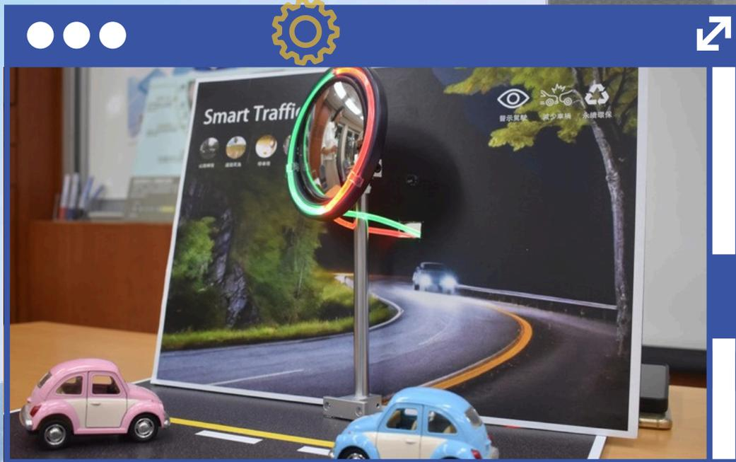
大多數交通事故發生在視線盲點。為了解決這個問題，許多凸面鏡被安裝，但在駕駛過程中很難準確判斷距離，這是因為晚上在駕駛時很難注意到凸面鏡，一般凸面鏡的可視距離僅有30公尺，而駕駛從反應到煞停平均需要22公尺，反應不及容易導致對撞。智慧凸面鏡結合了AI影像辨識距離攝像頭，並安裝在現有的凸面鏡上。當車子接近時，警示燈會以距離遠到近(綠黃紅)提醒駕駛來車。
