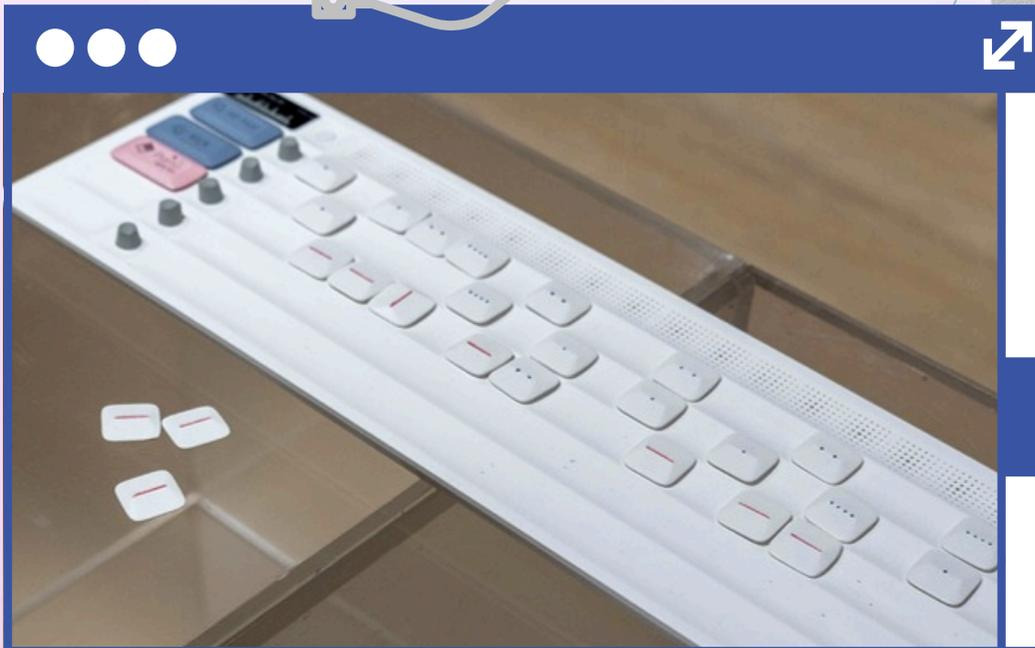
MUSCHESS”是一款實體音樂編曲工作站，承襲電腦編曲軟體的音檔排列編輯功能，以棋子與棋盤作為聯想，將編曲的設備和操作簡化，適合年齡介於3至15歲的入門音樂創作者。相較專業軟體，MUSCHESS更重視操作方便性及低、門檻練習方式，對初學者或而言，是探索靈感的好工具。透過內建AI音訊生成器，MUSCHESS能將簡易的音訊轉為有層次的專業伴奏。
