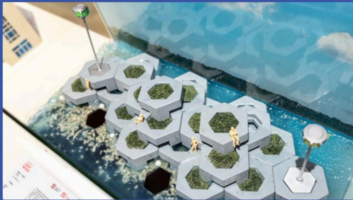
一坪海岸線結合消波塊與波浪能發電，將波浪動能轉為電能，供應AI感測器蒐集及預測波浪強度、潮汐數據，以波浪預測與安全提示，加強漁民作業安全與效率，也降低災害風險。消波塊以就地取材的牡蠣殼混合製作，以緩解海洋酸化。並結合藻類生長模組，構建與海洋生物的共生環境，採用六邊形結構以穩定沙岸，也提供居民行走於潮間。
