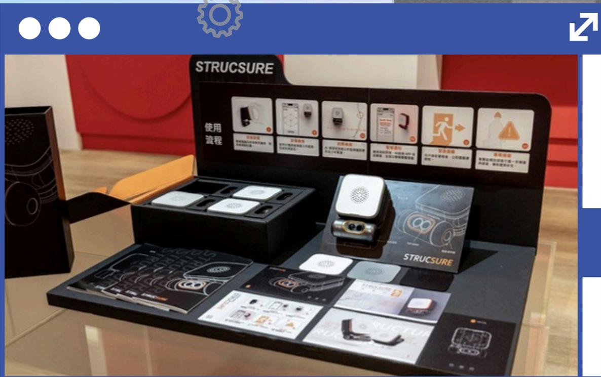
STRUCSURE 是智慧建築安全監測系統，透過 ToF 感測器與 AI 分析，長期監測結構變形，發現異常即時警報，提醒住戶應對。相比人工檢測，STRUCSURE 更即時、低成本且高效，適用於老舊建築與地震頻繁區域。結合雲端數據與 B2B、政府合作，STRUCSURE 成為建築安全監測的關鍵技術，守護居住環境。
