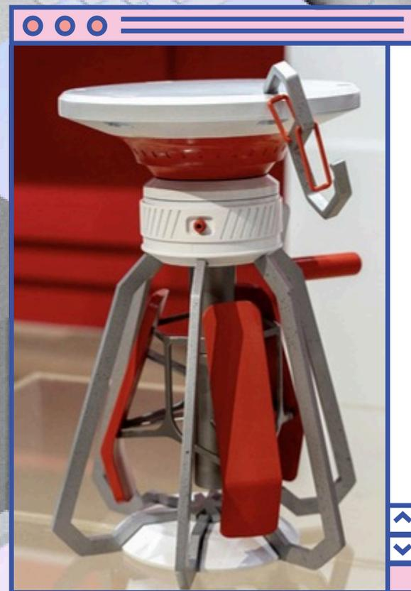
WWW是一家用緊急風力發電通訊裝置，當災難所導致的停電斷網時可藉手轉發電或將其放窗外以風力發電，且裝置內網路增強器結合AI分析可進行區域性網路調度，以利求救或上網，而儲存之電力可為手機充電、點亮燈泡。裝置有燈號可了解儲電量及通訊品質。整體使用六角柱支撐使裝置更穩固，倒掉後葉片也不會受影響。
